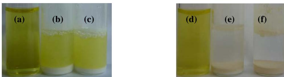
**Figura 2. 34.** Estudio del mecanismo de intercambio durante la preparación de Au/Nb<sub>2</sub>O<sub>5</sub>. Solución precursora 10<sup>-2</sup>M (a) y (d), N300 (b) y N800 (c) luego de tres horas de intercambio, N300 (e) y N800 (f) luego del lavado al NH<sub>3</sub>.
