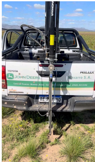
Figura 7. Detalle del barreno neumático Tornomar CH200 dispuesto sobre camioneta.
