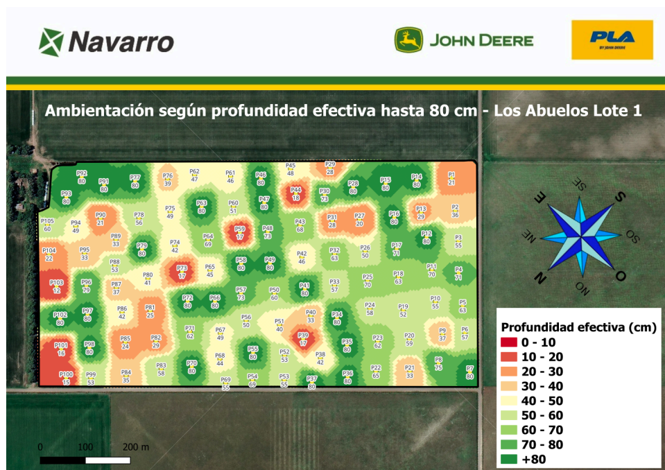
Figura 13. Mapa de ambientación según profundidad efectiva hasta 80 cm
