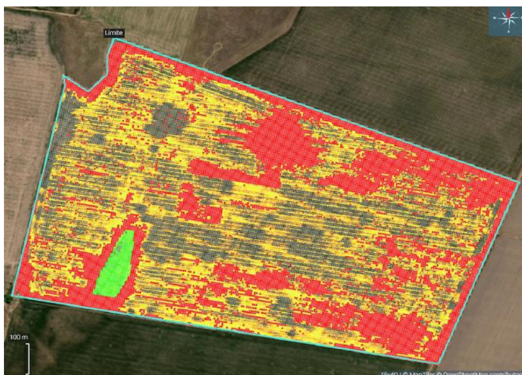
Figura 14. Mapa de prescripción para control de Lolium spp. elaborado mediante imágenes multispectrales procesadas en Pix4D. Rojo: presencia de maleza. Verde: loma.
