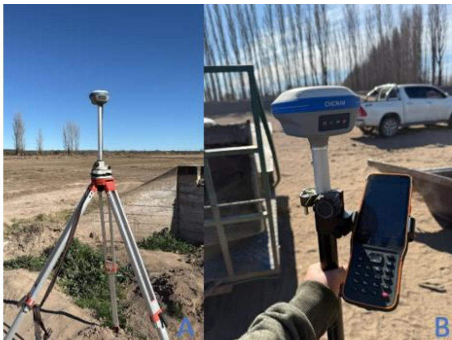
Figura 11. Base de la estación (A) y el rover (B) de un equipo GNSS RTK.
