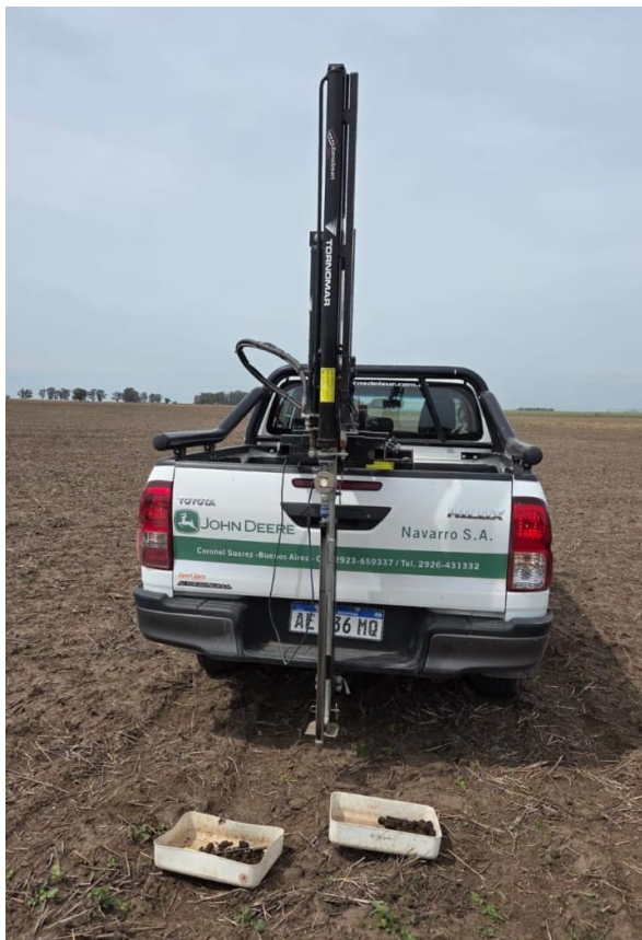
Figura 26. Toma de muestras con el calador hidráulico Tornomar CH200. Fuente: (Elaboración propia, 2025)
