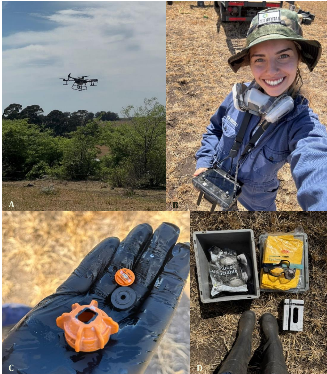
Figura 13 A. Aplicación de productos fitosanitarios con Dron DJI Agras T30 teniendo en cuenta las medidas de seguridad. A) Dron volando, B) conducción del dron, C) pastilla XR Teejet 01y D) elementos de protección personal.
