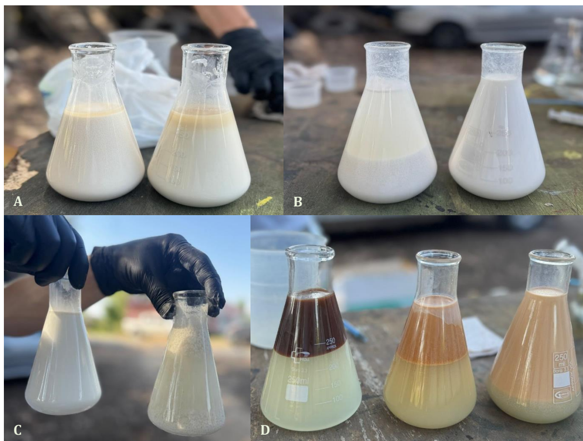
Figura 11. A) Comparación de un caldo cortado compuesto por Zidua + Atrazina + Glifosato, donde se aprecia la separación de fases testigo con caldo cortado y separación de fases (izq.) vs. adicionando A35T gold (der.). B) Testigo con caldo cortado y separación de fases (izq.). Tratamiento con ALL ok + A35T (der.). C) Testigo con tratamiento con ALL OK + A35T (izq.). Tratamiento cortado solo con A35T gold (der.) y D) testigo con caldo cortado (izq.). Trat. con 600cc de ALL OK aun caldo cortado (medio). Trat. con 800cc de ALL OK (der.).
