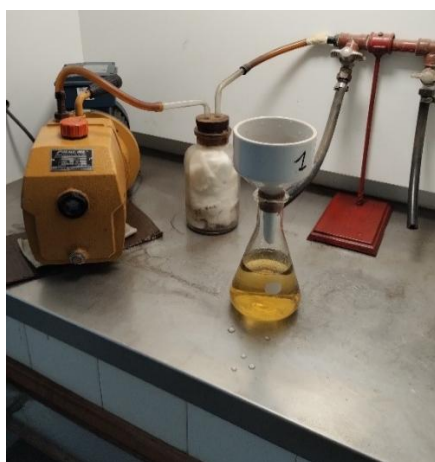
Figura 25: Filtración con bomba de vacío, Kitasato y embudo Bucher.
