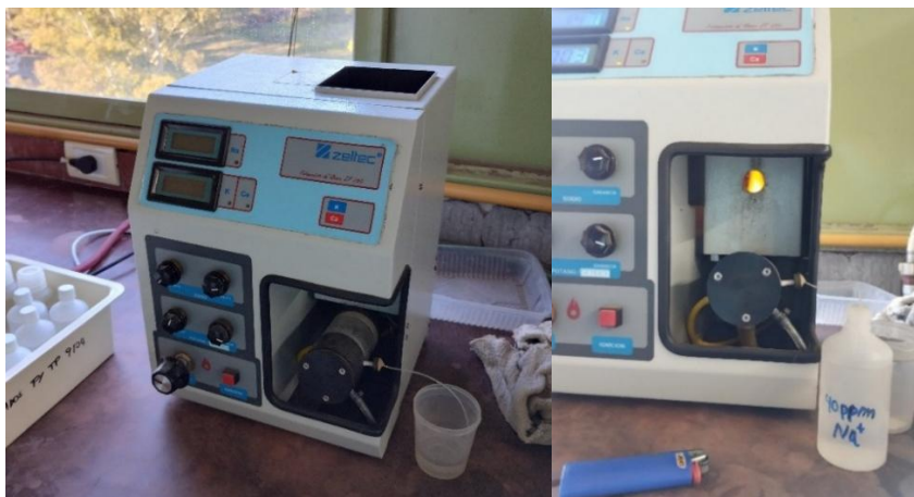
Figura 22: Fotómetro de llama. A la derecha se ve la llama.
