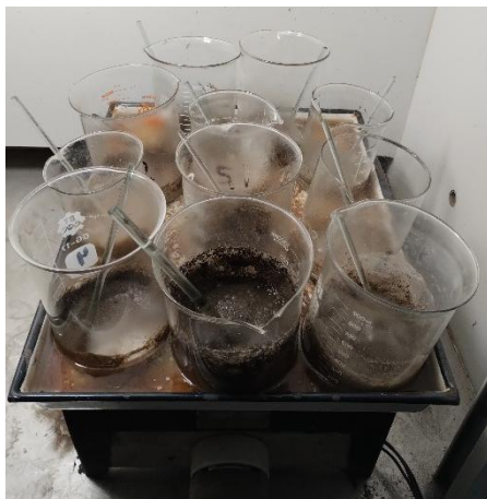
Figura 23: Vasos de precipitados donde se encuentran las muestras de suelo con sus respectivas varillas sobre plancha eléctrica luego de la aplicación de agua oxigenada.
