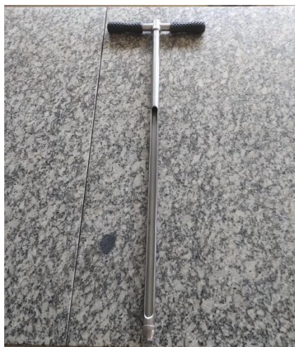
Figura 4: Herramienta de muestreo. Barreno calador inoxidable.
