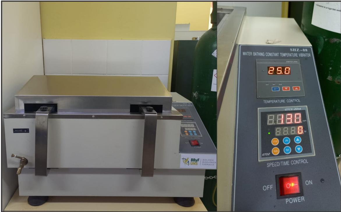
Foto 5.3.5b. Incubadora (SHZ 88) a 25°C con agitación constante a 130 rpm.
