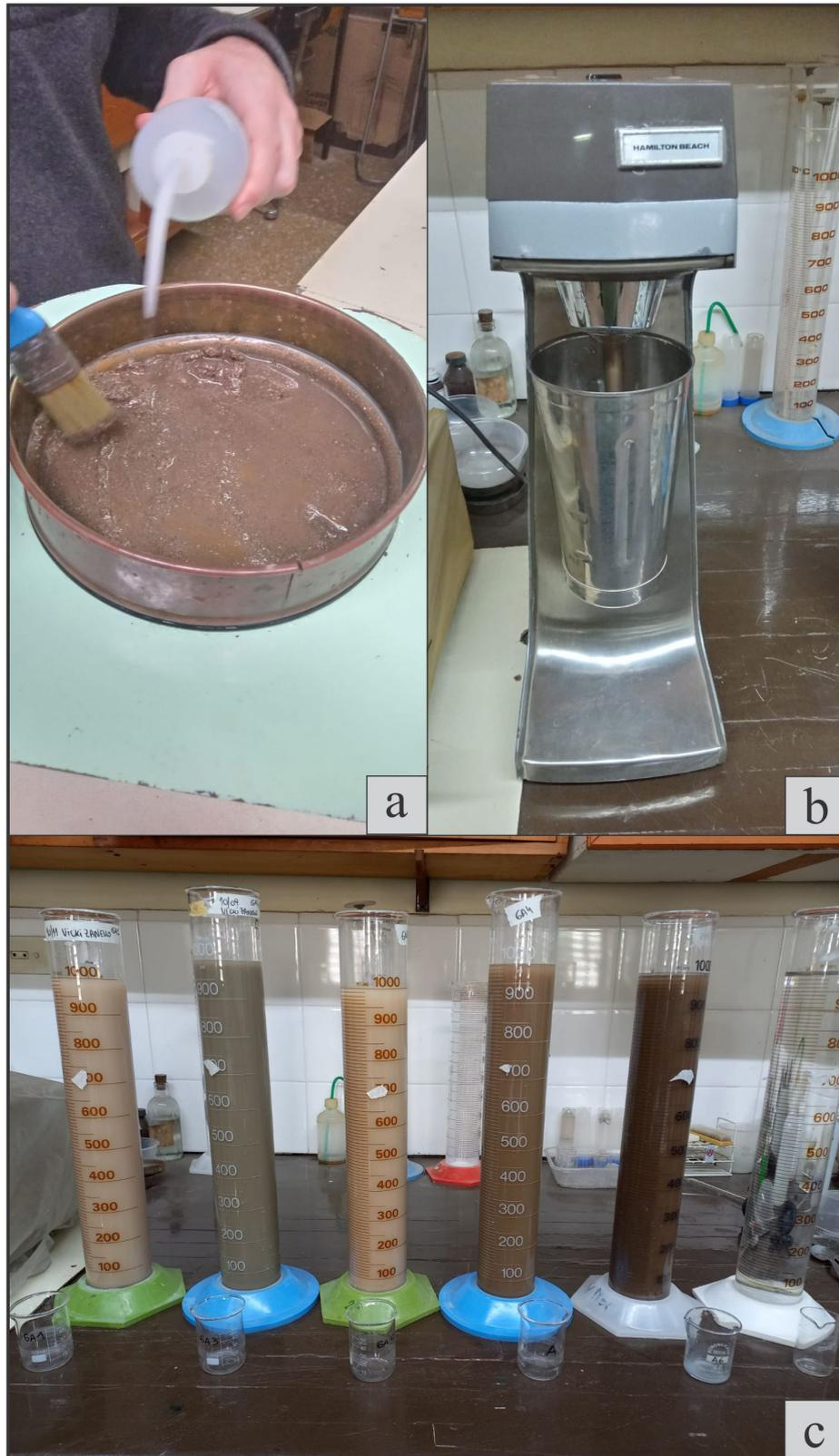
Foto 4.2.2. a) Tamizado en húmedo. b) Mezclador dispersor de sedimentos HAMILTON. c) Probetas graduadas con sedimentos en 1 l de agua destilada para método de la pipeta.
