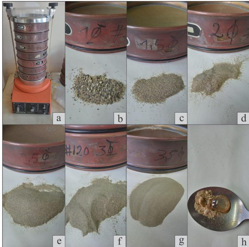
Foto 4.2.2. a) Tamizadora FRITSCH. b) Sedimento mayor a 0,5 mm. c-f) Sedimento entre 0,5 mm y 0,063 mm. g) Sedimento menor a 0,063 mm. h) Reacción de los sedimentos al HCl.
