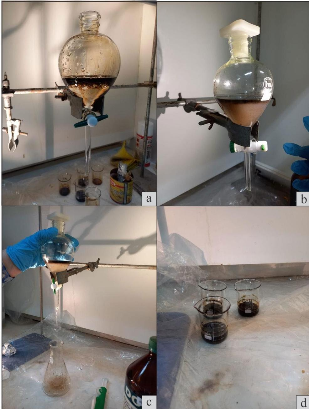
*Foto Anexo V.2 a) Ampolla control. b) Ampolla tratamiento. c) Separación de fases. d) Vasos de precipitado extracto hexánico.*
