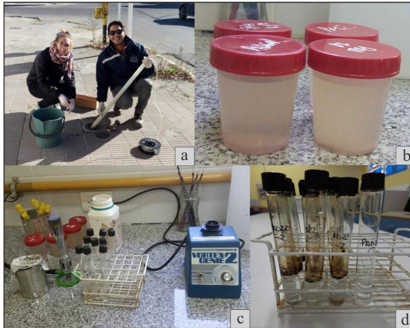
Figura 31. a) Toma de muestra desde pozo de monitoreo con muestreador tipo bailer. b) Frascos estériles donde se tomaron las muestras. c) Siembra de las muestras y sus diluciones. d) Tubos con siembra en medio Busnell Haas con petróleo crudo.
