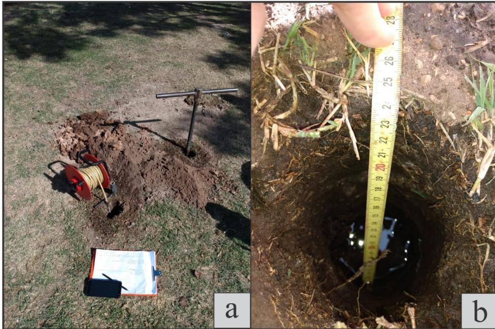
Figura 13. a) Pozos por duplicado para la realización del ensayo del sondeo inverso. b) Medición con sonda piezométrica del nivel de agua en el pozo 1.
