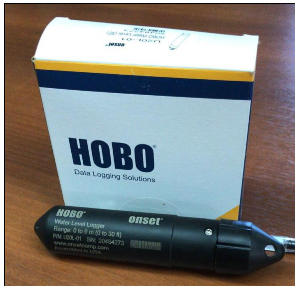
Figura 2.4.1.1. Freatímetro digital HOBO U20L utilizado para la medición continua de niveles.
