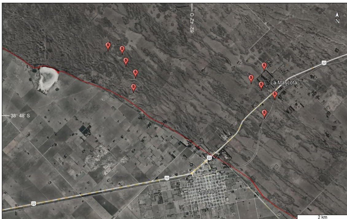
Figura 5.1.1. Ubicación de los SEVs realizados por Lexow y Bonorino (2012) en alrededores de Médanos y La Mascota, señalados con los íconos rojos. La línea roja marca el límite de la cadena de dunas.
