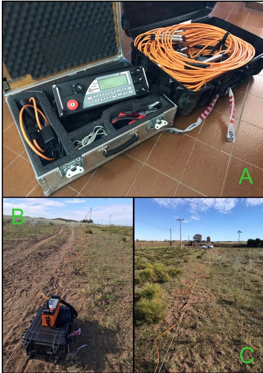
Figura 2.6.2.2. Tomógrafo GF Instruments ARES y electrodos (A). Equipo en operación (B y C).
