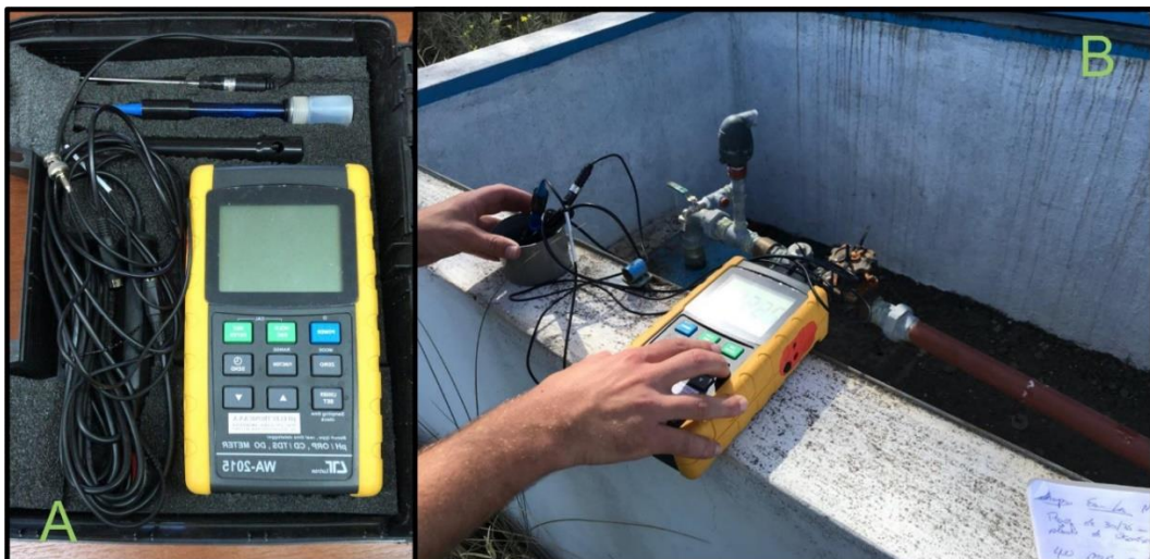
Figura 2.4.3. Sonda multiparamétrica Lutron WA-2015 para pH, temperatura, conductividad y TDS in-situ (A) y toma de mediciones en campo (B).
