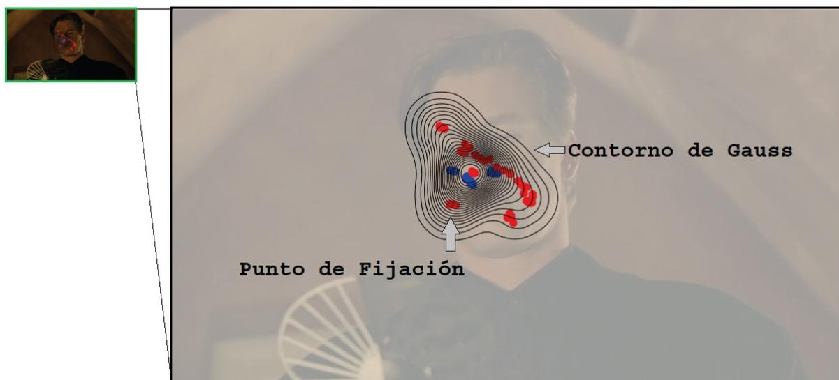
**Figura 6.4:** Vista de Estímulo. En cada fotograma del clip, se dibujan sobre éste las distintas fijaciones de los participantes que lo vieron. Las fijaciones son agrupadas empleando una función de densidad Gaussiana y coloreadas en función de su valor de correlación con el valor de pupila correspondiente.
