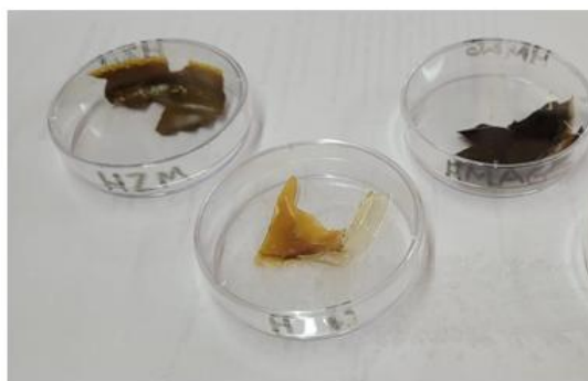
Figura 12. Aspecto de hidrogeles. De izquierda a derecha, hidrogeles HZM, H, HMag. (H) hidrogel quitosano, (Z) nanopartículas de óxido de zinc, (M) morina, (Mag) nanopartículas de Magnetita.
