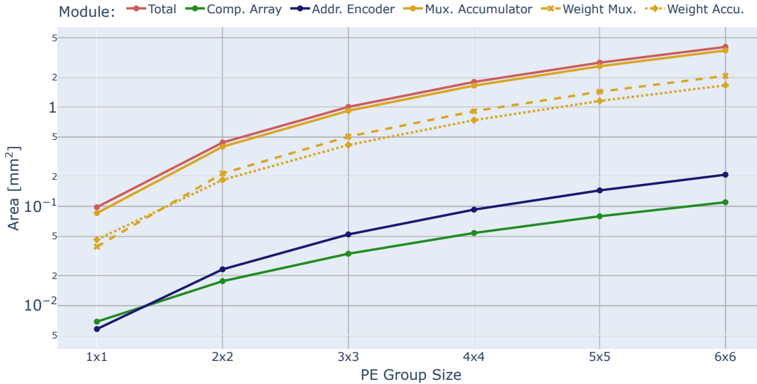
Figura 4.15: Área del core ChSymSim y sus módulos, en función del tamaño de grupo de PEs, con kernel de tamaño 3 \times 3 y 8 features de salida por PE.
