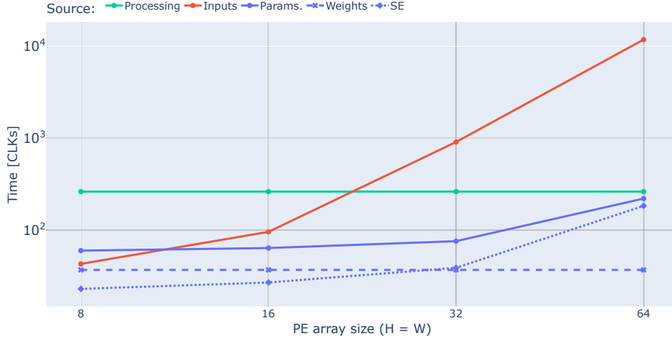
Figura 4.11: Influencia en el tiempo total de la capa Layer3 1 de ResNet18 ChSymSim (Tabla D.1), por parte del procesamiento en sí mismo, carga de entradas y escritura de parámetros, para 8 features de salida.
