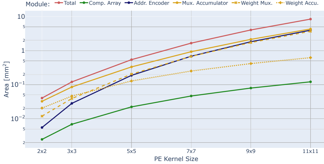
Figura 4.13: Área del operador ChSymSim y sus módulos, en función del tamaño del kernel, para un solo grupo de PEs y 8 features de salida con diferente SE para cada uno.
