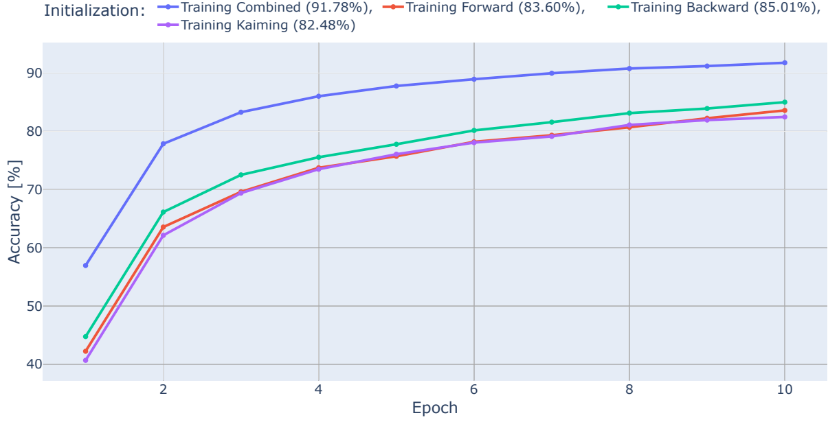
Figura 3.5: Primeras 10 épocas de entrenamiento de ChSymSim ResNet06 (Tabla D.4) para clasificación del dataset EuroSAT (Training), en base a diferentes inicializaciones: Combined (producto \gamma\hat{\gamma} ), Forward ( \gamma ), Backward ( \hat{\gamma} ), Kaiming (normal) [5].
