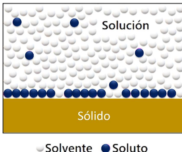
Figura 1.1. Esquema del proceso de adsorción en solución.
