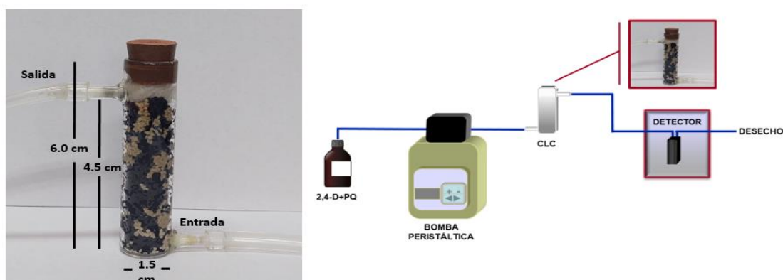
Figura 2.12. a) Foto de la CLC con sus respectivas dimensiones; b) Esquema del sistema de flujo.
