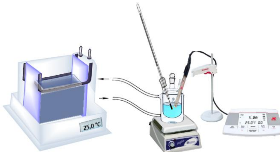
Figura 2.9. Esquema de montaje experimental utilizado para realizar las cinéticas de adsorción y desorción
