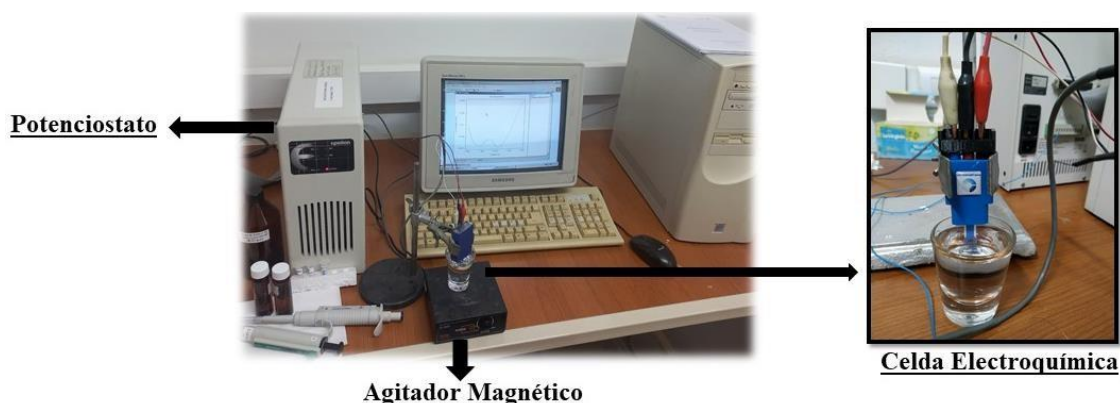
Figura 4.17: Sistema de medición usado para los análisis electroquímicos.
