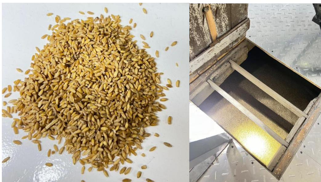
Figura 7. Grano húmedo y silos de reposo CMS.
