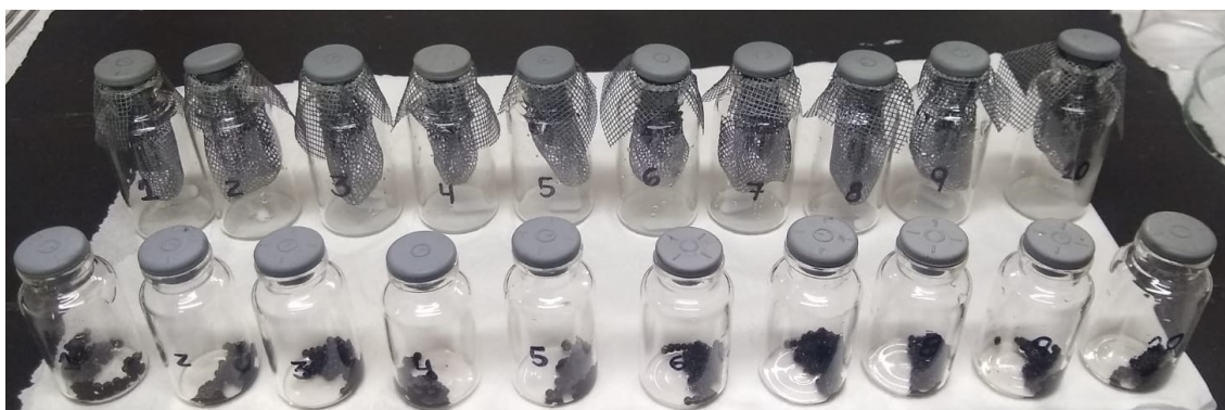
Figura 5.3 – Viales con malla de fibra de vidrio empleados para la inmovilización de HEM sobre esferas de QUIT-MAG-TPP-APTS.
