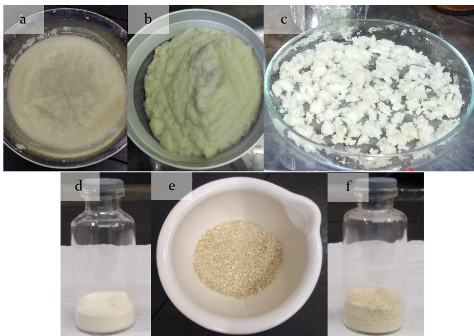
Figura 8.4 – Biomasa (a) triturada y lavada con agua destilada; (b) filtrada; (c) secada en estufa (50 °C); (d) tamizada en malla 74 micras (B2m); (e y f) granulometría mayor a 74 micras (B2M).
