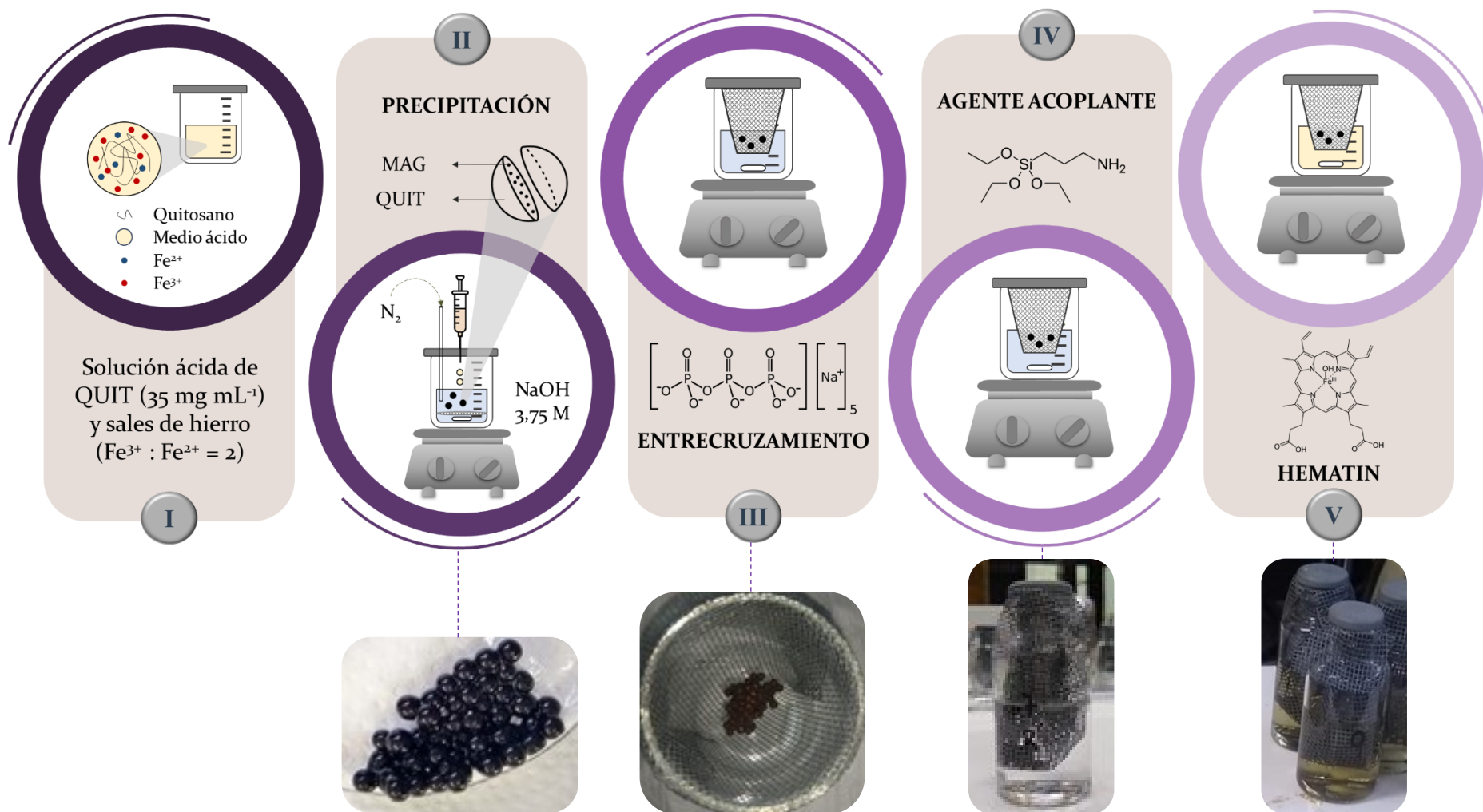
Figura 5.4 – Esquema del protocolo de síntesis del catalizador con la incorporación de APTS como agente acoplante.
