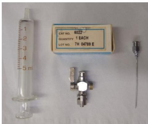
Figura 5.2 – Sistema utilizado para el trasvase de APTS.
