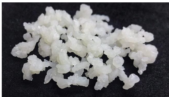
Figura 3.6. Imagen de un cúmulo de pellets de C4g obtenidos por extrusión reactiva de CPE4 en presencia de DBPH y AM.
