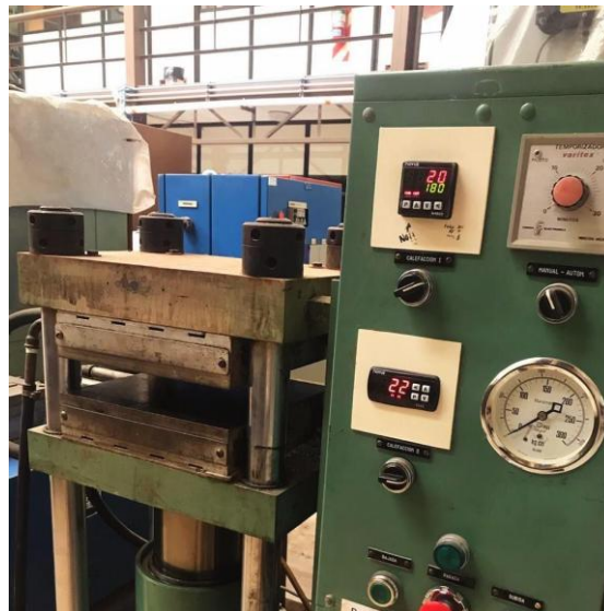
Figura 3.10. Prensa utilizada para la elaboración de películas y discos de sistemas poliméricos.
