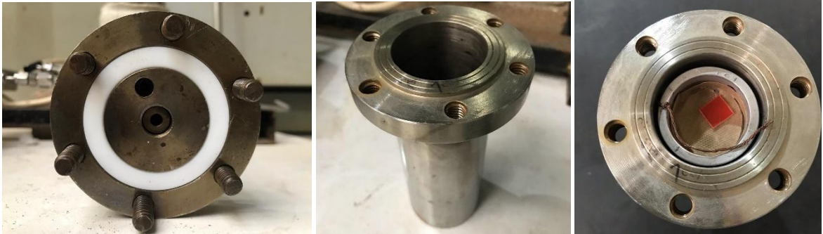
Figura 3.24. Recipiente de acero inoxidable con tapa roscada y sello de teflón donde se coloca el portamuestras.
