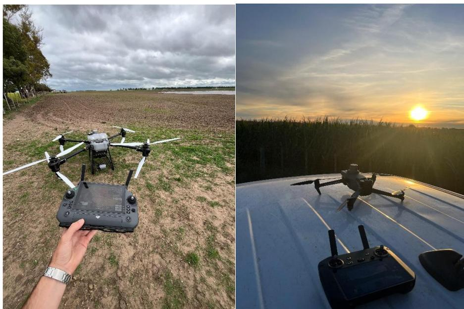
*Figura 19: Dron aplicador Agras T50 (izquierda), Mavic 3 multiespectral (derecha).*
