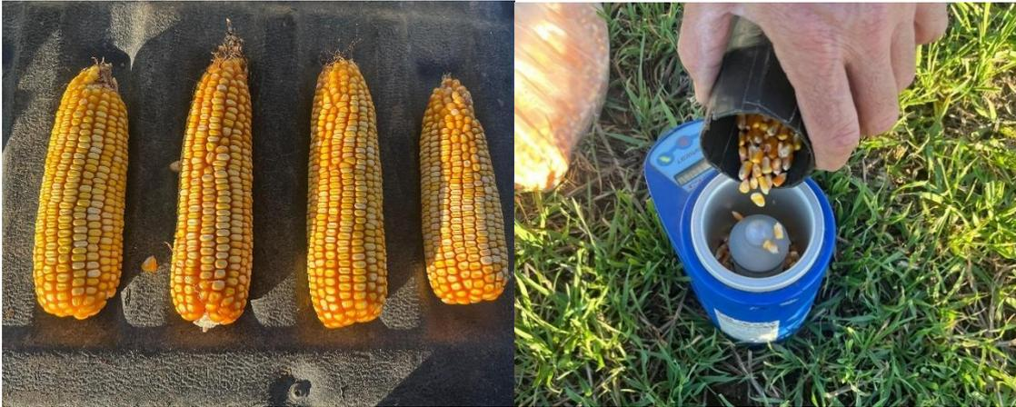
Figura 13: toma de muestras (izquierda), medición de humedad (derecha).
