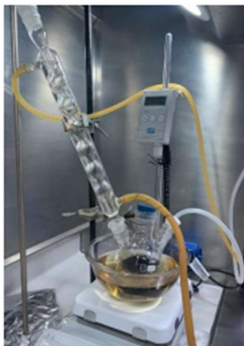
Figura 36: Dispositivo empleado en la síntesis de sGO.
