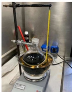
Figura 35: Dispositivo empleado para la síntesis de rGO.
