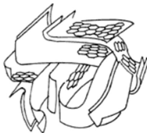
Figura 3.1: Representación esquemática de la estructura de un carbón activado (Martín Martínez, 1990).
