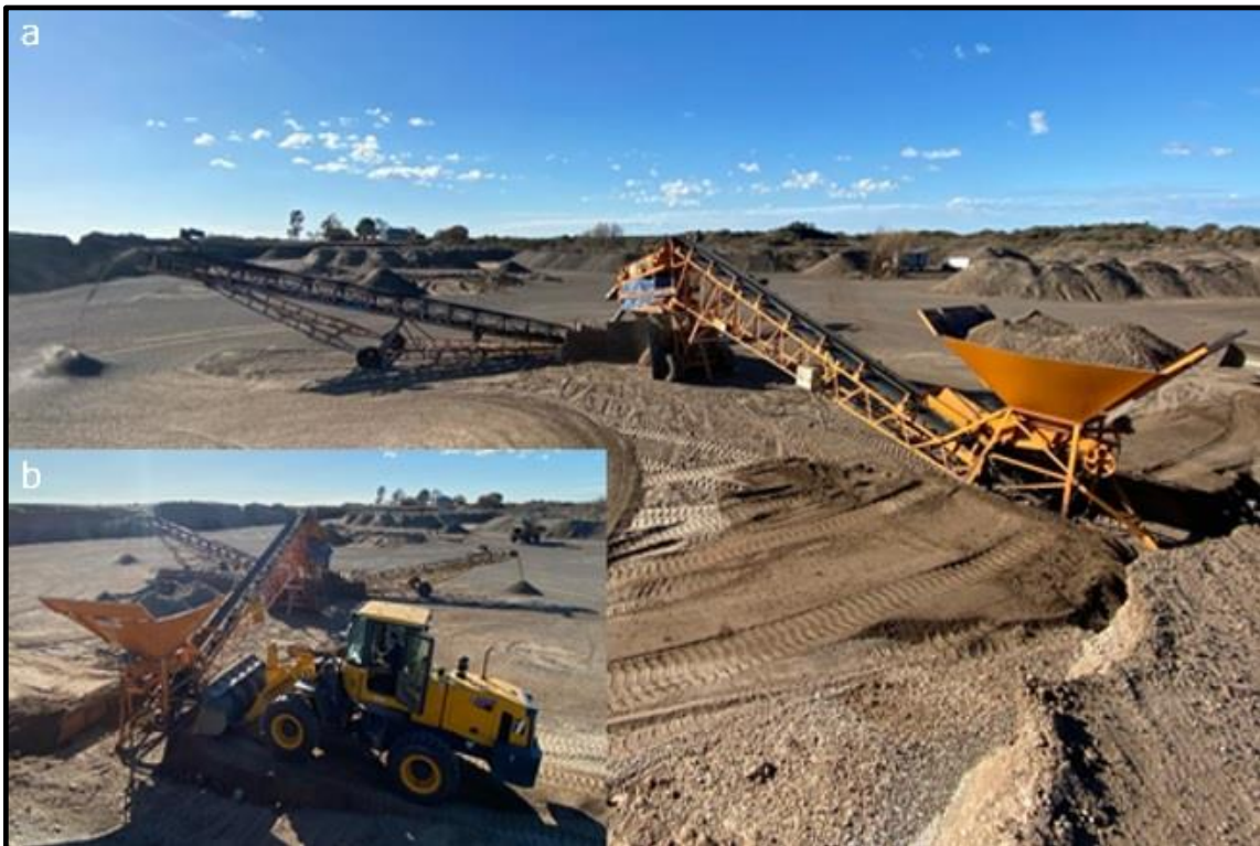
Figura 3.9 Cantera VIL de canto rodado y arena a) y b) equipos de selección de material vía tamizado
