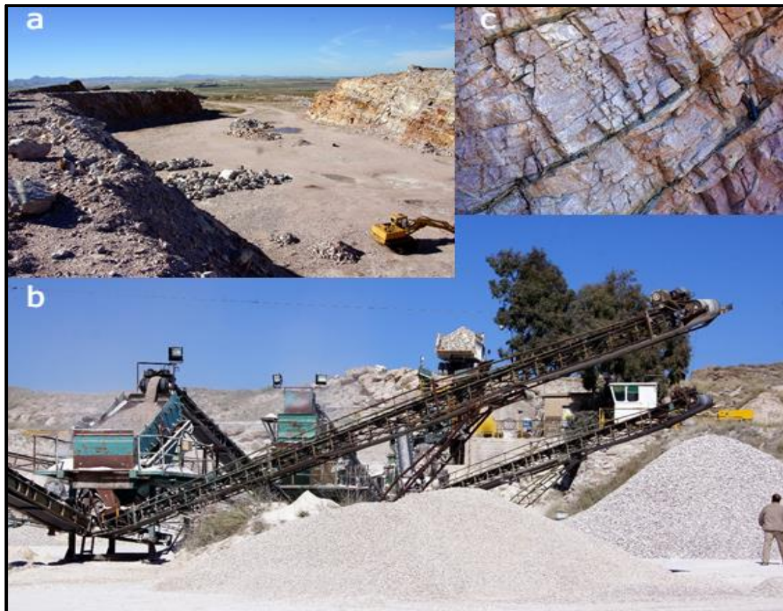
Figura 3.6 Cantera PIG a) Frentes de explotación; b) equipos de trituración y clasificación de materiales; c) frente de explotación norte. Niveles de ortocuarcita con intercalaciones de arcilla
