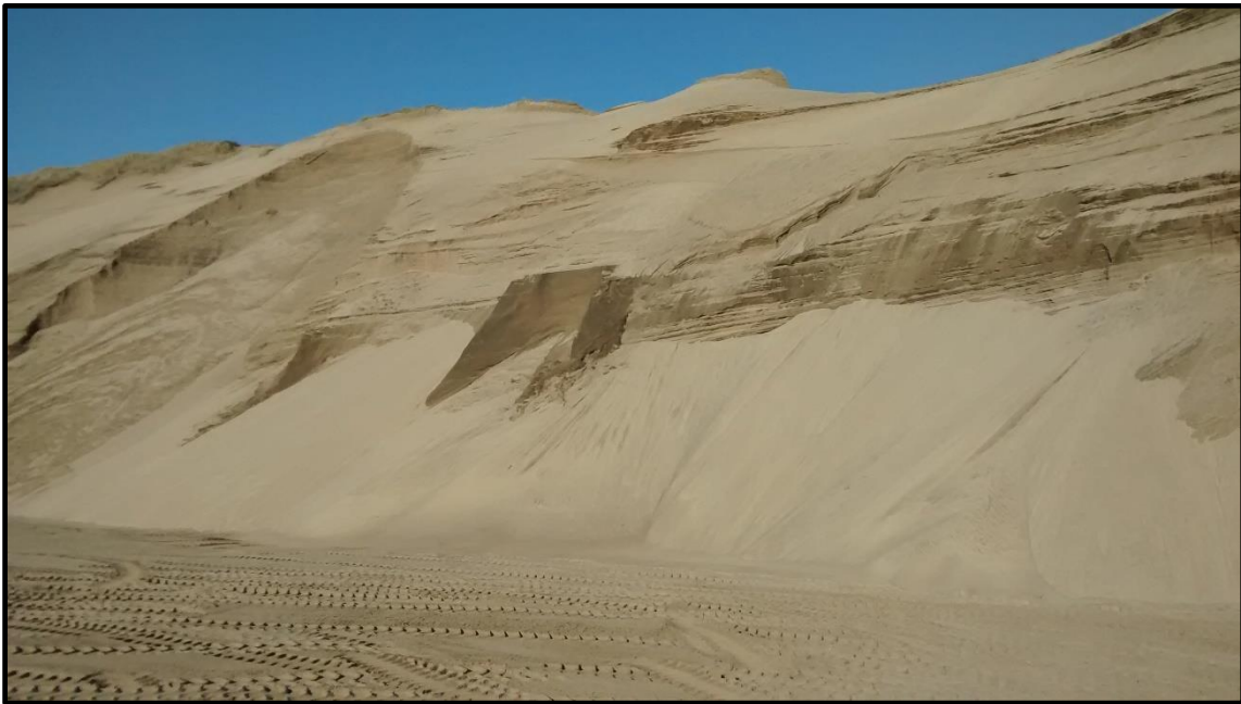
Figura 3.19 Frente de explotación de Cantera NEC. Potencia de 8 metros de altura
