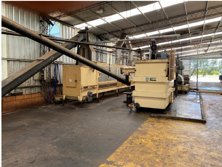
Figura 34: en esta figura se puede visualizar a la izquierda el secador de expeller y a la derecha el decantador de borras mecánico,
