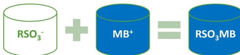
**Figura 3.** Representación esquemática de la formación del par iónico  $\text{RSO}_3\text{MB}$ . Donde  $\text{RSO}_3^-$  representa el anión sulfonado de un AS y  $\text{MB}^+$  representa el azul de metileno catiónico.
