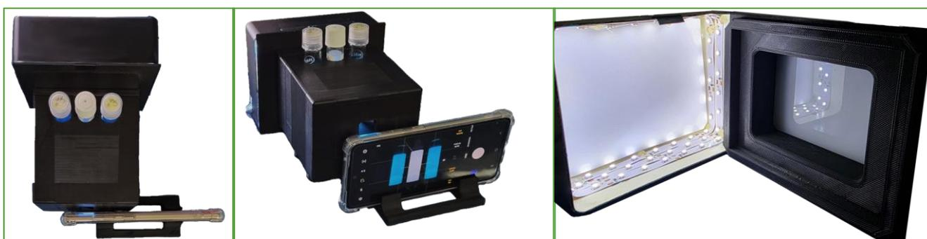
**Figura 6.** Sistema modular portátil de análisis imageno-colorimétrico impreso en 3D (Sistema IC) basado en el uso de un smartphone acoplado al portaceldas múltiple (MCH). De izq. a der.: vista superior del sistema IC; vista en perspectiva del sistema IC; vista del interior de la caja de luz, la interfase de acoplamiento MCH-Caja de luz, y de la pantalla difusora.
