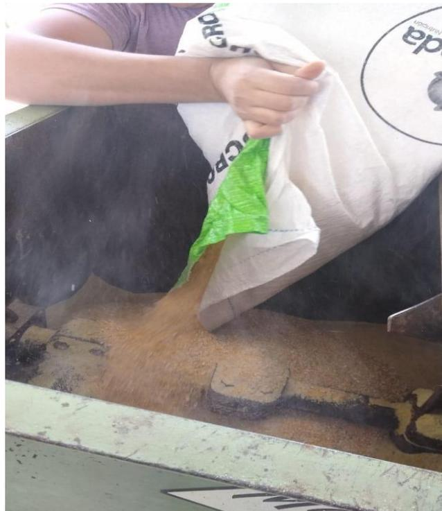
**Imagen 3.** Preparación de una de las dietas, con mezcladora “Marion Mixer”, fabricada por “Rapids Machinery Company” - Marion, Iowa (EE. UU.), disponible en el DA-UNS.
