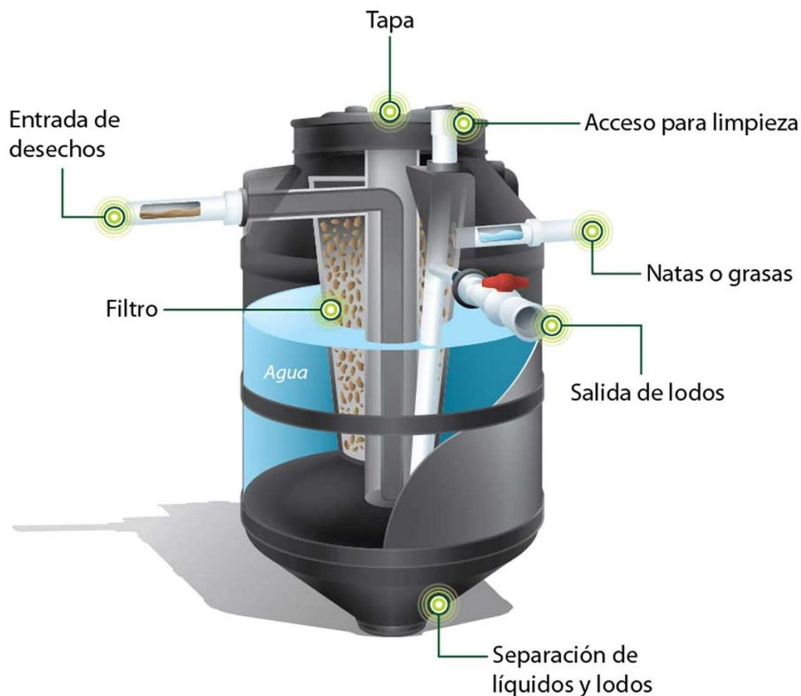
Imagen 76: Diagrama de funcionamiento de Biodigestor
