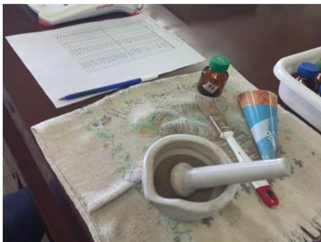
Figura 11. Homogeneizado de la muestra luego del tamizado en húmedo.
