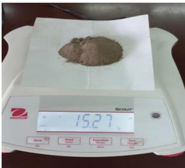
Figura 10. Muestra seca a estufa de la fracción gruesa ( $>53 \mu\text{m}$ ).
