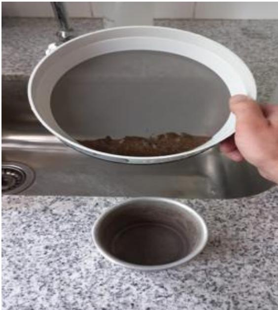
Figura 9. Muestra tamizada correspondiente a la fracción gruesa (arenas + MOP).
