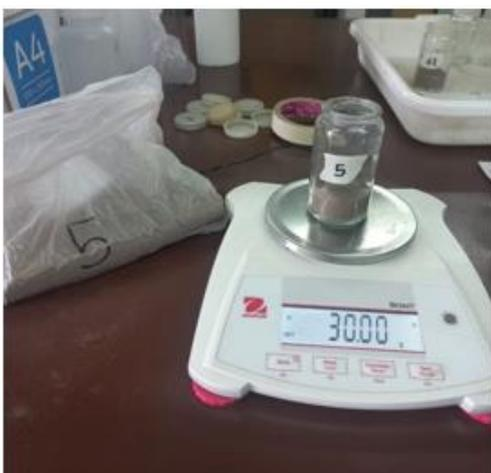
Figura 5. Frasco con 30 g de suelo identificado con número de muestra.
