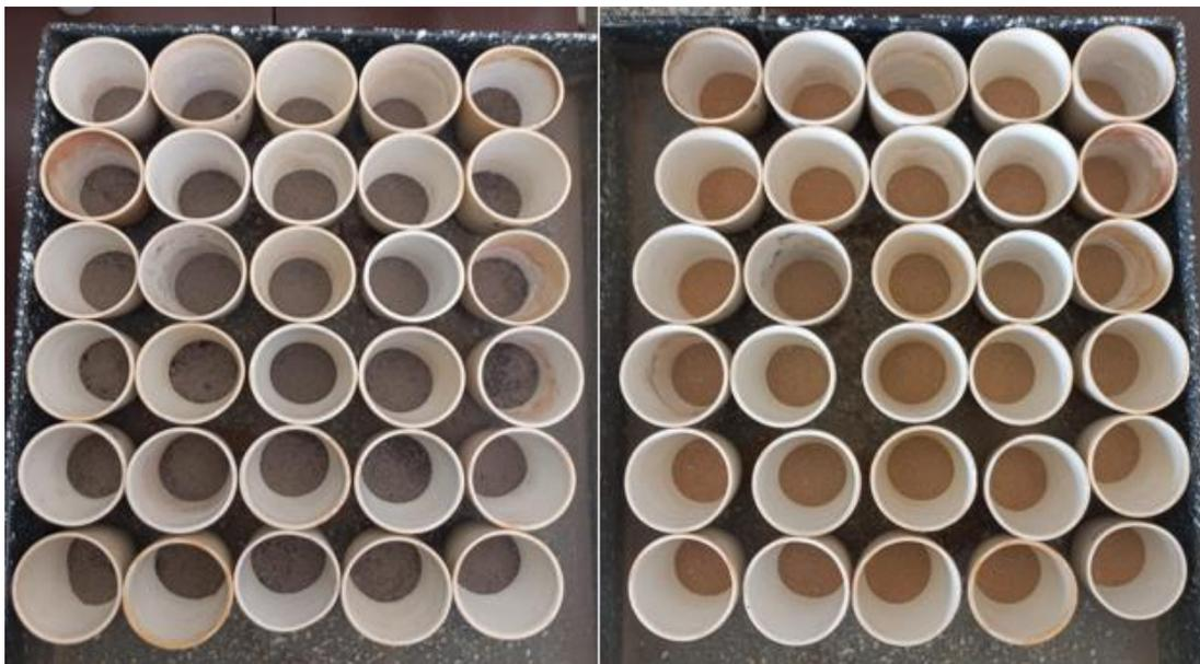
Figura 14. Muestras antes (izquierda) y después (derecha) del tratamiento en mufla a  $550 \text{ }^{\circ}\text{C}$ , mostrando el cambio de color asociado a la pérdida de materia orgánica.
