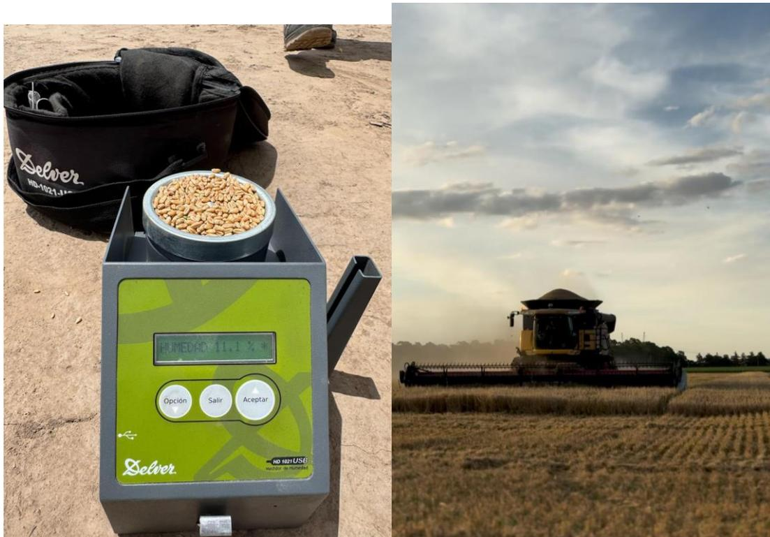
Figura 33. Muestreo para control de humedad.
