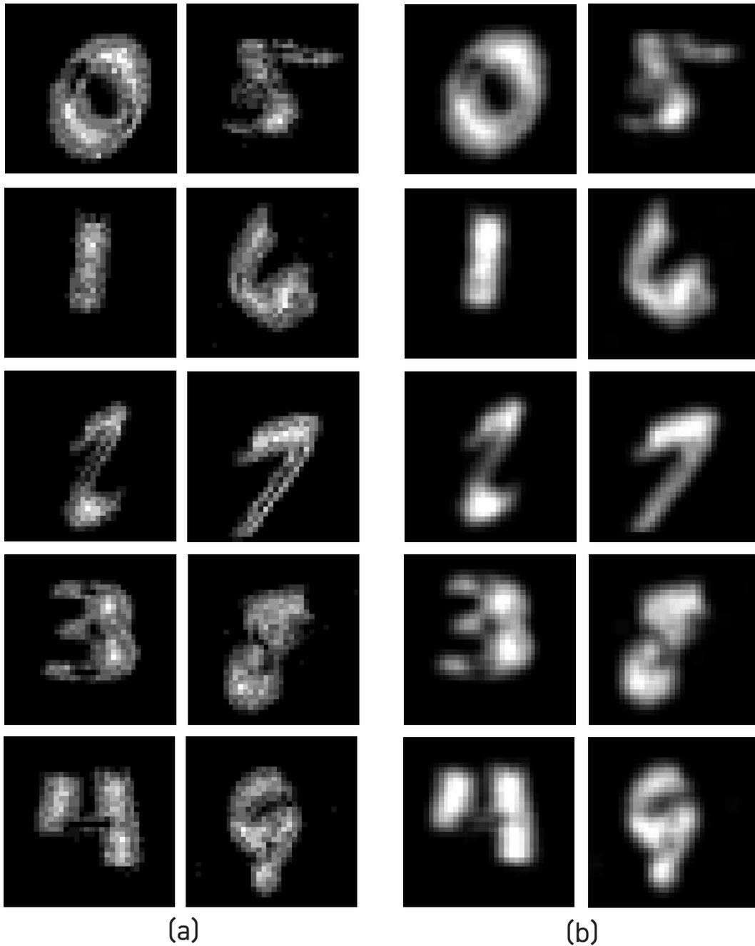
Figura 5.10: Aplicación de un filtro gaussiano  $3 \times 3$  a los dígitos de N-MNIST: (a) imagen dispersa de entrada; (b) resultado procesado por el ASIC.
