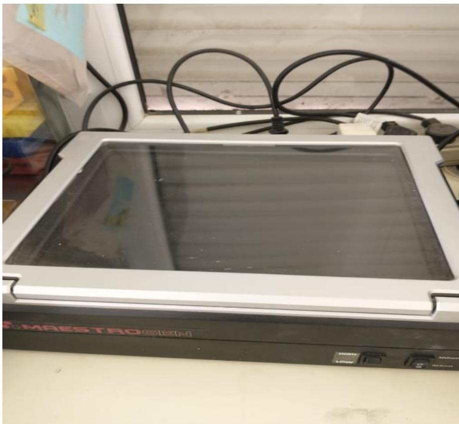
**Figura 8:** Transiluminador Maestro-Gen utilizado para visualizar el resultado de electroforesis.
