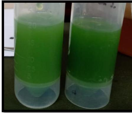
**Figura 10. Imagen del producto de la dispersión ZnO NPs y biomasa algal de *Haematococcus pluvialis*.** A la izquierda se observa la dispersión preparada respetando la proporción ZnO NPs : *H. pluvialis* (1:1); y la derecha se observa la dispersión obtenida al emplear ZnO NPs : *H. pluvialis* (2:1). Se percibe la característica acuosa, color verde y homogeneidad de cada dispersión.
