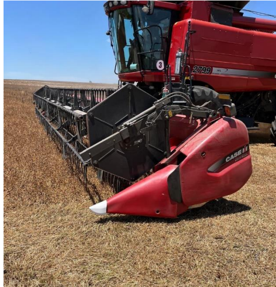
Figura 16. Plataforma bien abajo para levantar cabezuelas.
