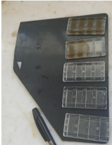
Figura 16. Cámaras de MCMASTER para recuento de HPG de nematodos parásitos mediante técnica de flotación.
