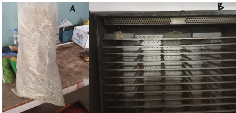
Figura 10. A. Muestra del heno ofrecido tomada para análisis de composición química. B. Estufa de aire forzado utilizada para el secado.
