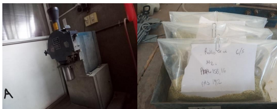
Figura 11. A. Molino para moler muestras destinadas a análisis de laboratorio. B. Muestras molidas de oferta de heno de alfalfa (T1) y heno de sainfoin (T2).
