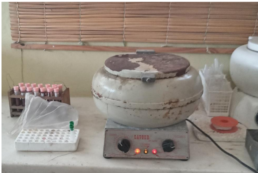
Figura 19. Centrifuga utilizada a 3000 rpm para la determinación de hematocritos en los animales del ensayo.
