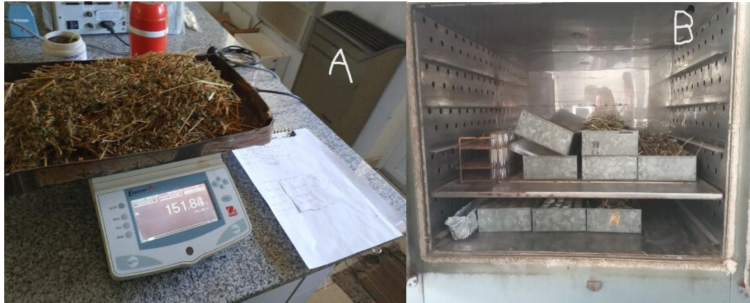
Figura 13. A. Peso de submuestra de remanente para determinación de materia seca (MS). B. Estufa de aire forzado utilizada para secado de muestras de remanente.
