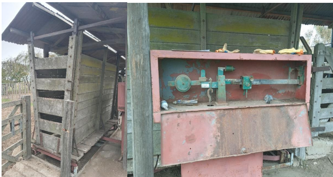
Figura 14. Balanza para pesaje individual utilizada para determinar el peso de los terneros.
