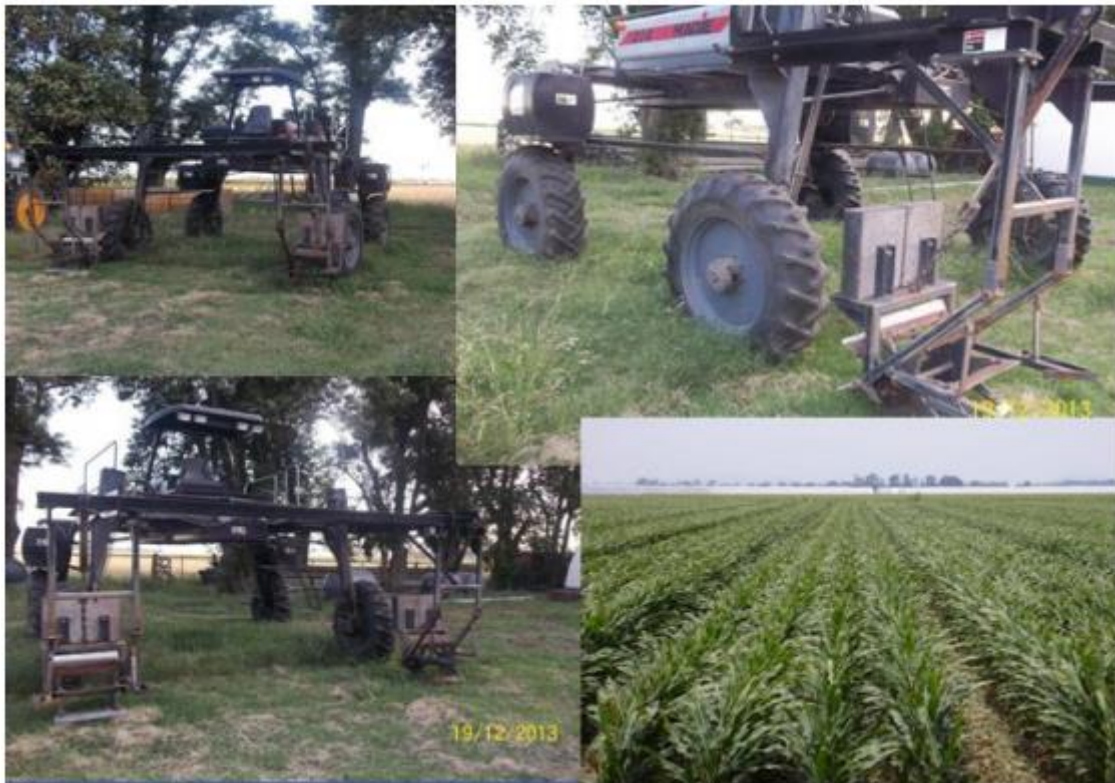
Figura 17. Vista de la maquinaria picadora de las líneas macho.
