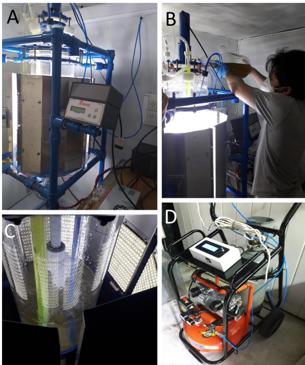
Figura 4.2. Preparación de inóculos de H. coffeaeformis en fotobiorreactor cilíndrico. A) Fotobiorreactor cilíndrico de 25 L Figmay. B) Inicio del inóculo en fotobiorreactor. C) Crecimiento de inóculo en fotobiorreactor. D) Sistema de inyección de aire con un 1 % de CO 2 (v/v).
