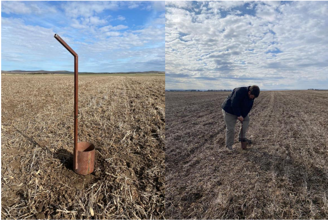
Figura 18: Muestreador de balde y utilización del mismo
