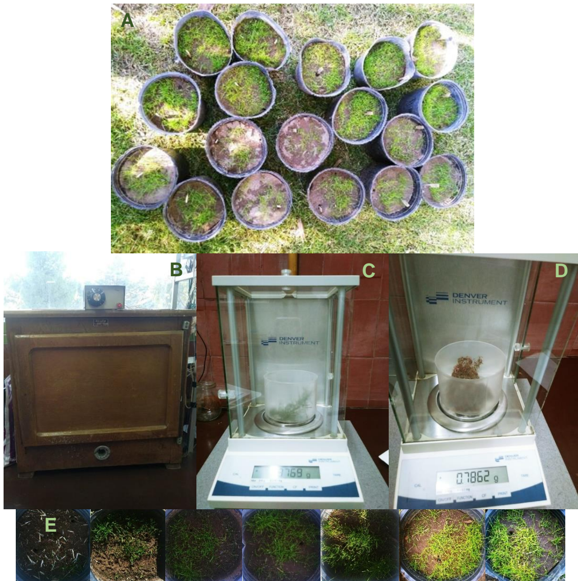
Figura 10. A) Bloque previo a ser fragmentado en biomasa aérea y subterránea. B) Estufa donde se llevaron las muestras a fin de secar el material. C) Balanza analítica pesando el total de raíces de una maceta. D) Balanza analítica pesando el total de biomasa aérea de una maceta y, E) Secuencias de imágenes en tiempo para calcular el porcentaje de cobertura de suelo de con la aplicación móvil Canopeo®.
