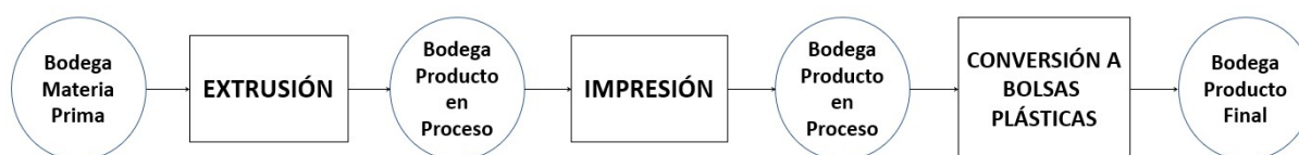
Fig. 2.1 Esquema simplificado del proceso de producción de bolsas de la planta
