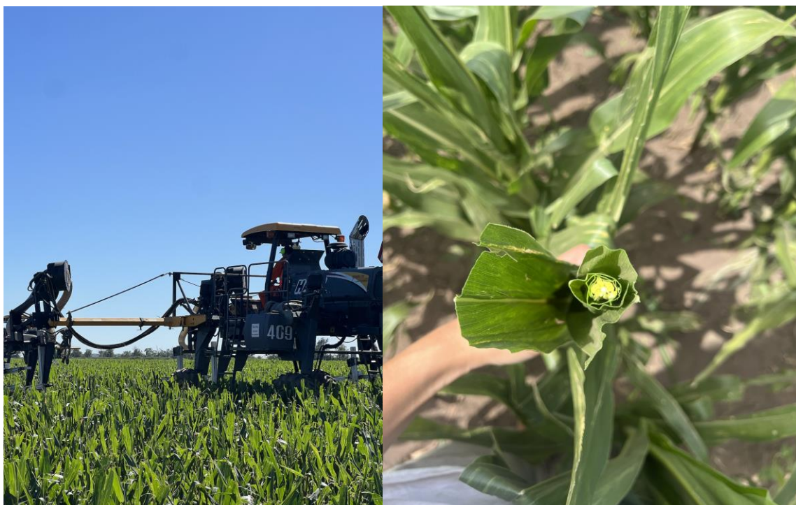
Figura 32: Cortadora mecánica y su resultado sobre las panojas. Fuente: propia.
