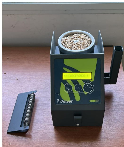
Figura 11: humidímetro Delver procesando una muestra. Fuente: propia.
