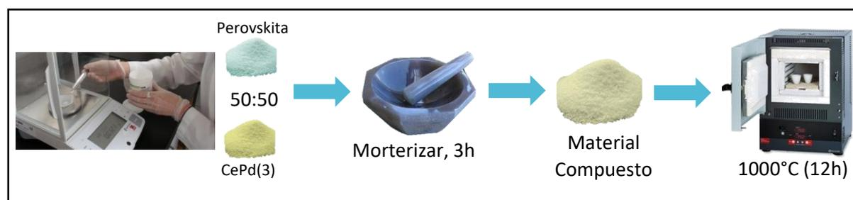
**Figura 2.4.- Preparación de los materiales compuestos.**
