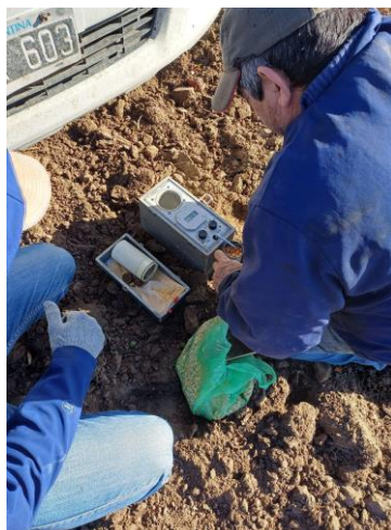
Figura 22 a. Medición de humedad con humedímetro Delver HD-1000-DD.
