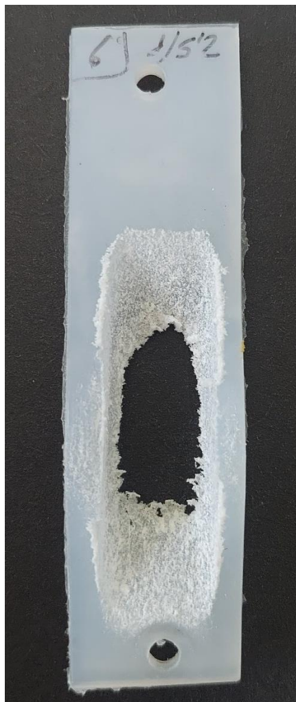
Figura 3.9- Placa de PE2.5 luego de ser ensayada durante 30 minutos usando AG como agente abrasivo.
