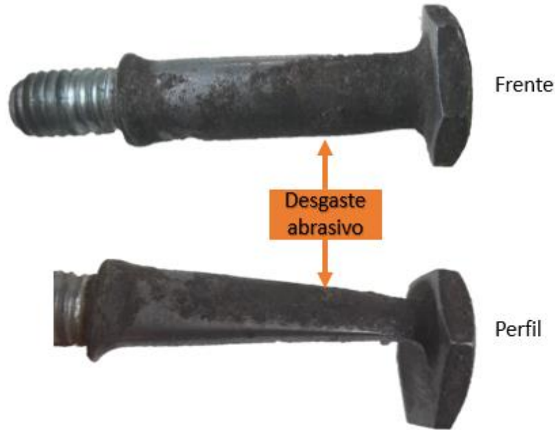
Figura 2.10- Buje metálico de cortadora de pasto desgastado por abrasión de tres cuerpos.
