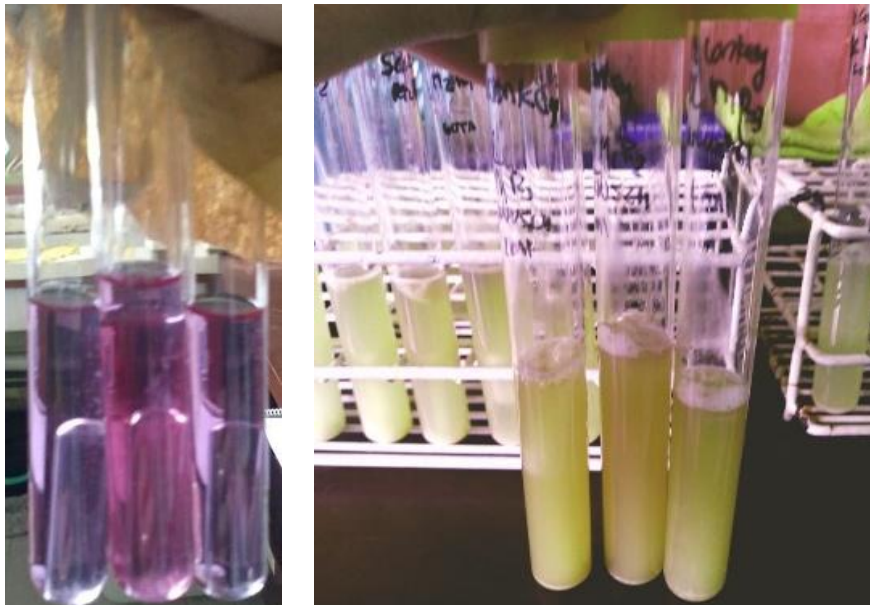
Imagen 8. Tubos de ensayo con caldo Mac Conkey. Prueba de determinación de coliformes totales mediante la técnica del NMP. Izquierda: tubos con medio Mac Conkey y campana de Durham. Derecha: resultados positivos evidenciados con viraje de color y acumulación de gas en campana de Durham.
