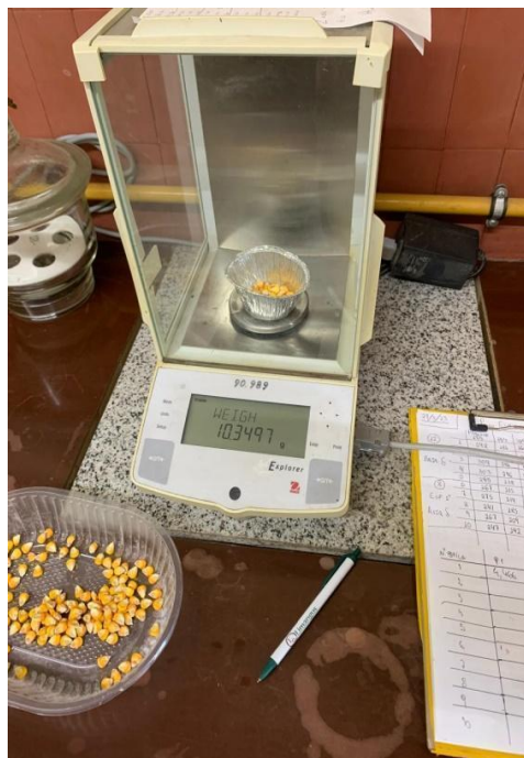
Figura 30. Balanza de precisión, utilizada para pesar 20 granos del tercio medio de cada espiga.
