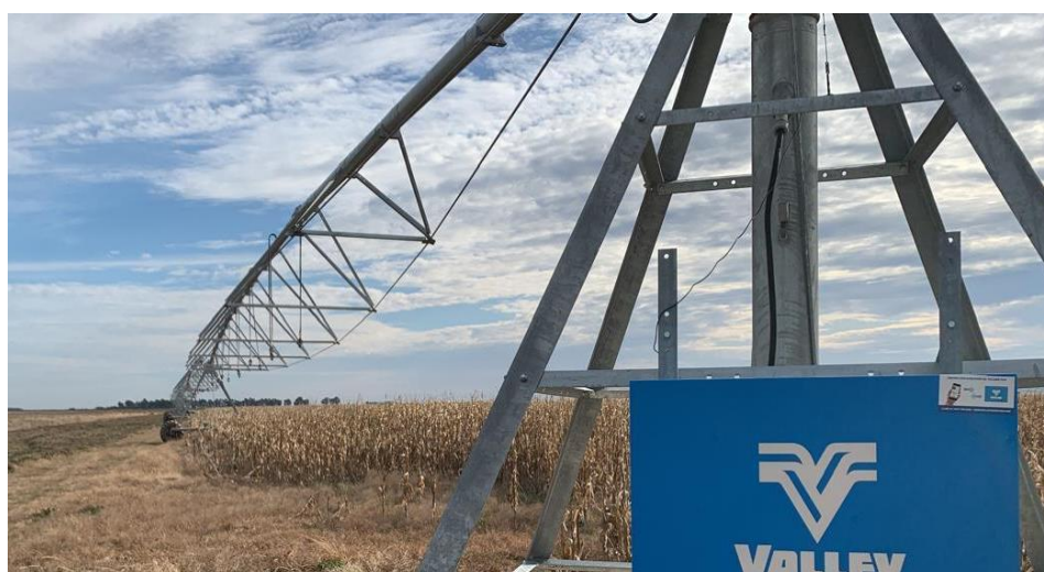
Figura 18. Equipo de riego por pívot central, utilizado en el estudio.
