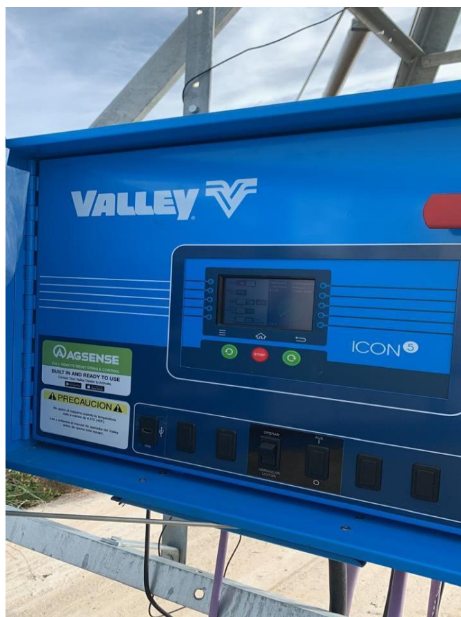
Figura 19. Monitor digital de control del pívot de la marca Valley.
