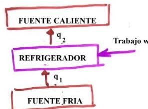
Figura 5-2: Esquema de una máquina refrigerante.
