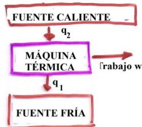
Figura 5-1: Esquema de una máquina térmica.
