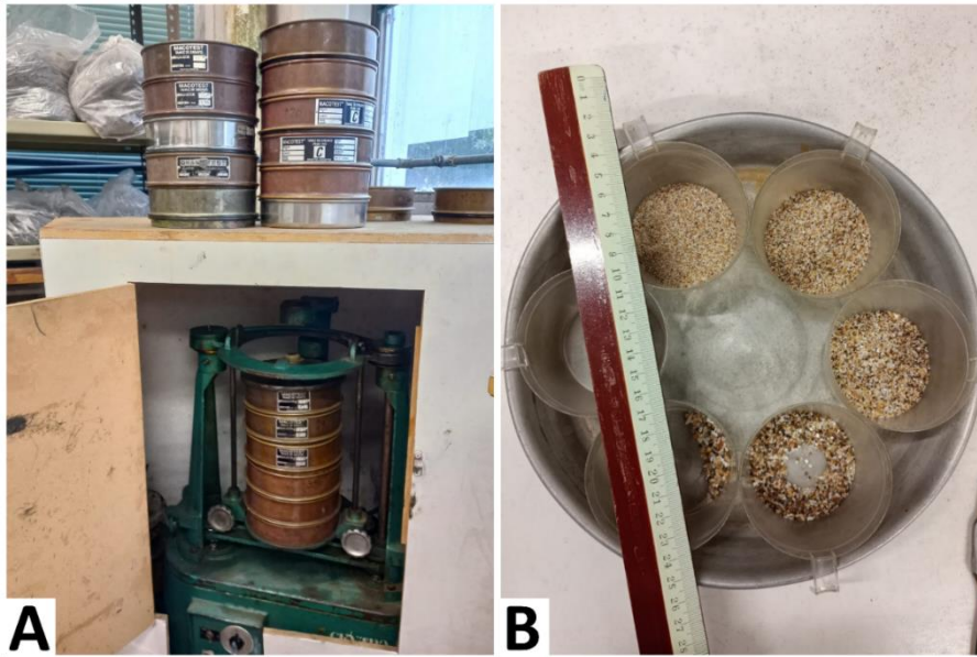
Figura 4.5. Columna de tamices y tamizadora ro-tap utilizados para el análisis granulométrico [A]; proceso de separación de arenas post-tamizado cada 0,5 unidades phi [B].
