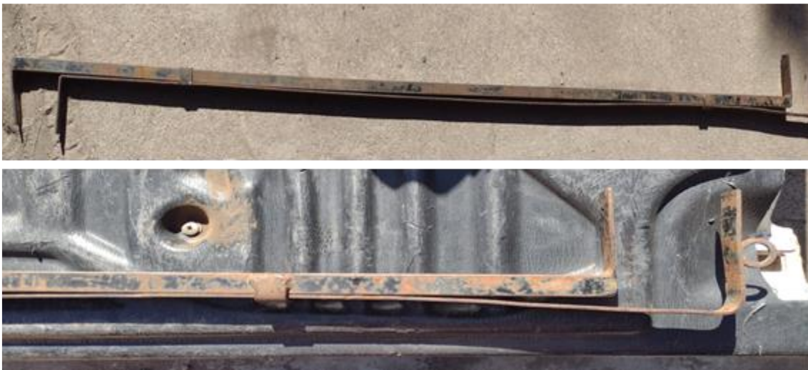
Figura 20. Vistas de un aforador, compuesto de dos piezas móviles.
