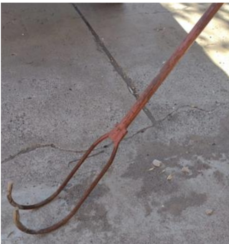
Figura 16. Gancho para muestreo de lama en los canales de riego
