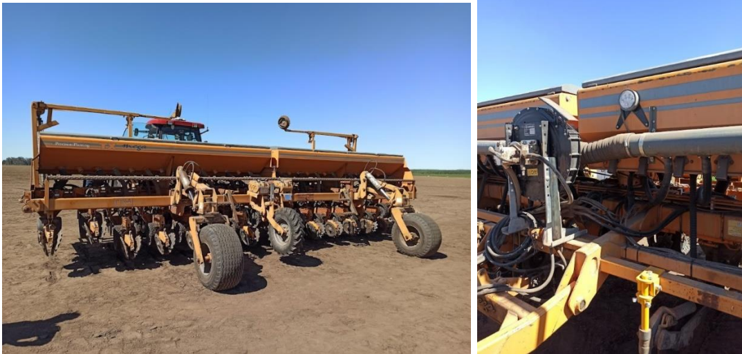
Figura 25. Izq. Sembradora de grano grueso Agrometal TX Mega. Der. Turbina de la sembradora.
