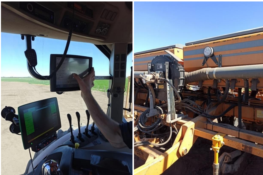
Figura 11. Izq.: monitores de siembra. Der: Turbina de succión neumática.
