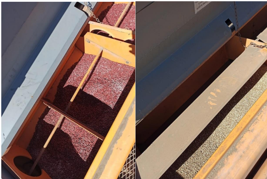
Figura 12. Izq.: cajón de semillas. Der: cajón de fertilizante (FDA).
