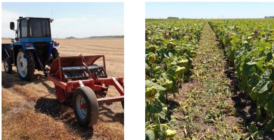
Figura 17. Izq. Tractor New Holland con el rolo triturador de machos. Der. Trabajo realizado en la eliminación de los machos.
