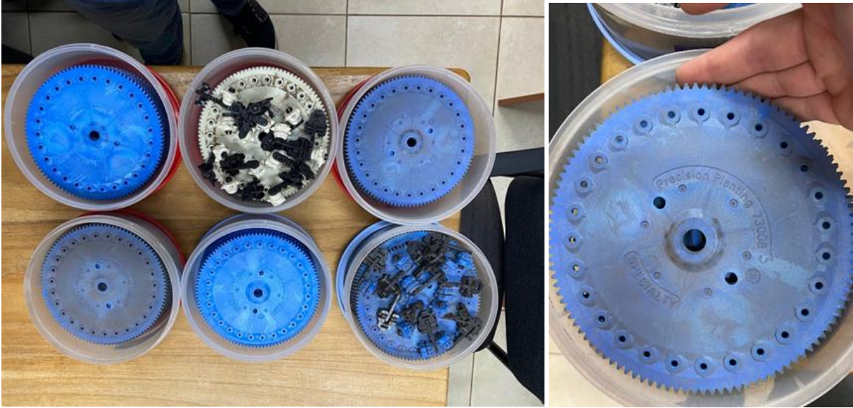
Figura 26. Placas dosificadoras de Precision Planting.
