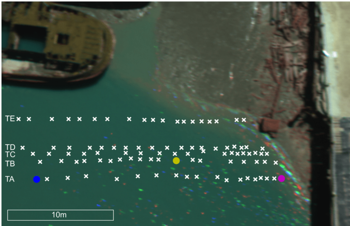
Figura 4.3: Transectos de batimetría en el área de estudio sobre una imagen a pseudocolor adquiridos mediante un sonar abordo del vehículo EMAC-USV. Los puntos en color y de forma circular representan las mediciones con profundidad mayor (azul), media (amarillo) y menor (magenta).
