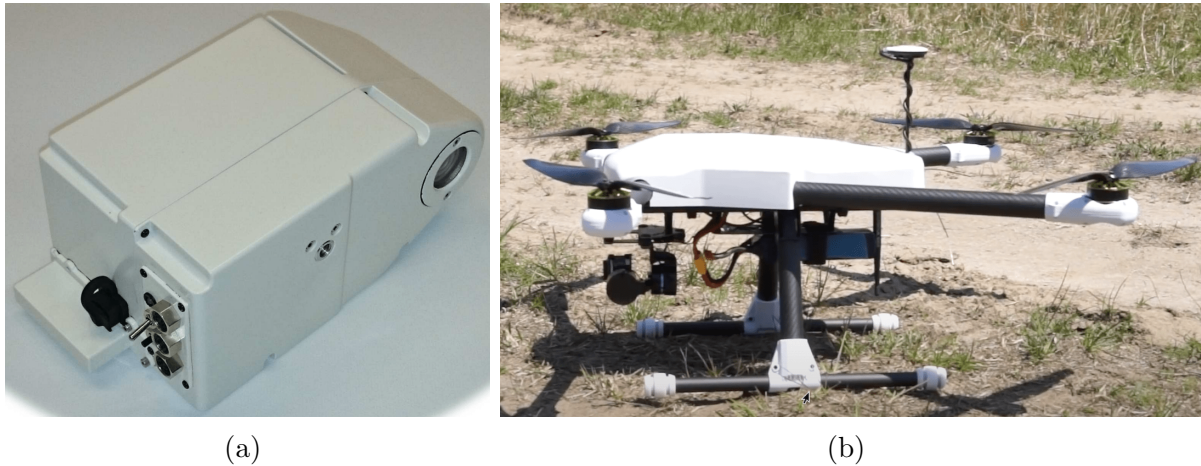
Figura 4.4: Adquisición de imágenes hiperespectrales: (a) Cámara hiperespectral Rikola. (b) Vehículo aéreo no tripulado (UAV).
