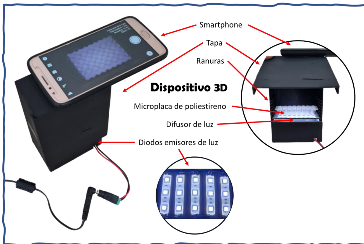
Figura 3.2.1 Detalles de los componentes del dispositivo impreso en 3D.
