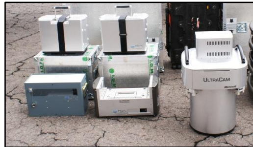
Fig. 19: Sistema de cámara métrica digital ULTRACAMP XP del IGM. Fuente: Elaboración propia, sobre la base de los equipos del IGM.
